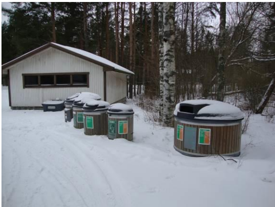
Kuva 4.1.7. Jätepiste lajitteluineen on toteutettu tilavin ns. Molok-säiliöin. Havaintojen mukaan aluetta käytetään myös tupakointipaikkana.
