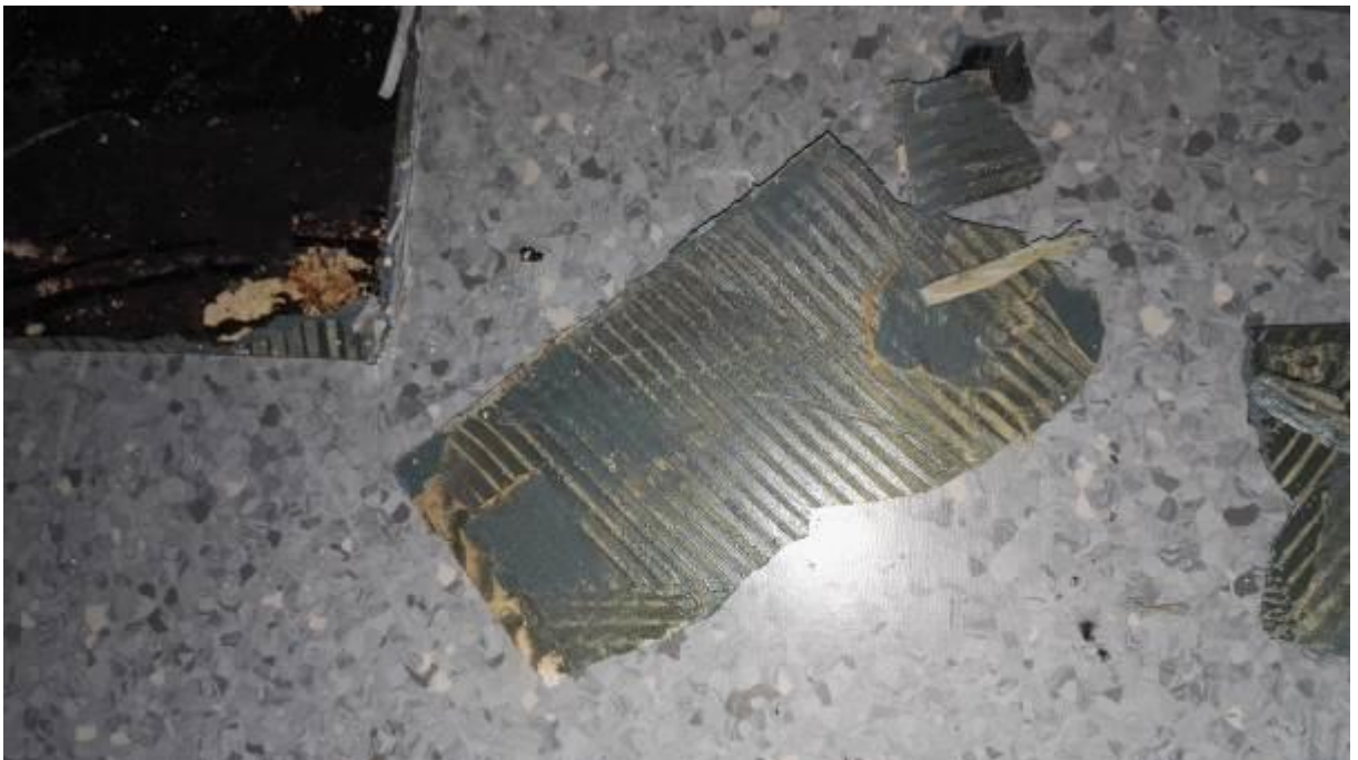
Kuva 7.8.2.2. Näyte 2, 1. krs aula, vinyylilaatoitus, vihreä ja näyte 3, 1. krs aula: vinyylilaatoituksen liima ja tasoite.
